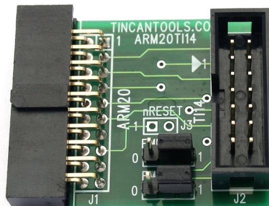
Abbildung 8 ARM20TI14-Adapter. Quelle: tincantools.com
